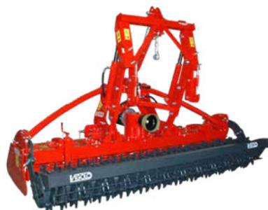
Der hydraulische Drillmaschineanbau Mod. ASI N ist ein Erweiterungssatz, mit dem Sie die Kreiselegge einfach und schnell mit einer mechanischen/pneumatischen Drillmaschine kombinieren können, wodurch die Handhabung und Bearbeitung erleichtert wird. Der Hydraulikanbau Drillmaschine verringert zudem die Gesamtabmessungen des Fahrzeugs beim Straßentransport deutlich und trägt so zu mehr Fahrkomfort und Verkehrssicherheit bei.
